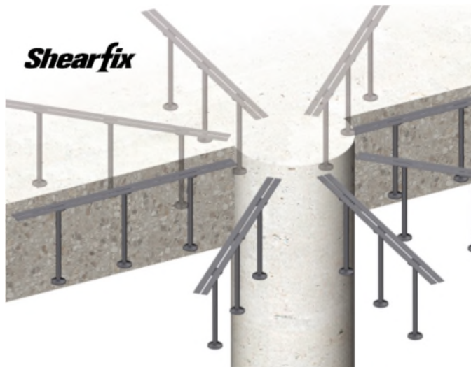
Figur 4-2 Exempel på skjuvankare www.ancon.co.uk
